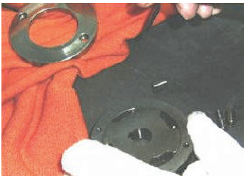
圖 4-12 可搬型吊籠自動控速裝置
