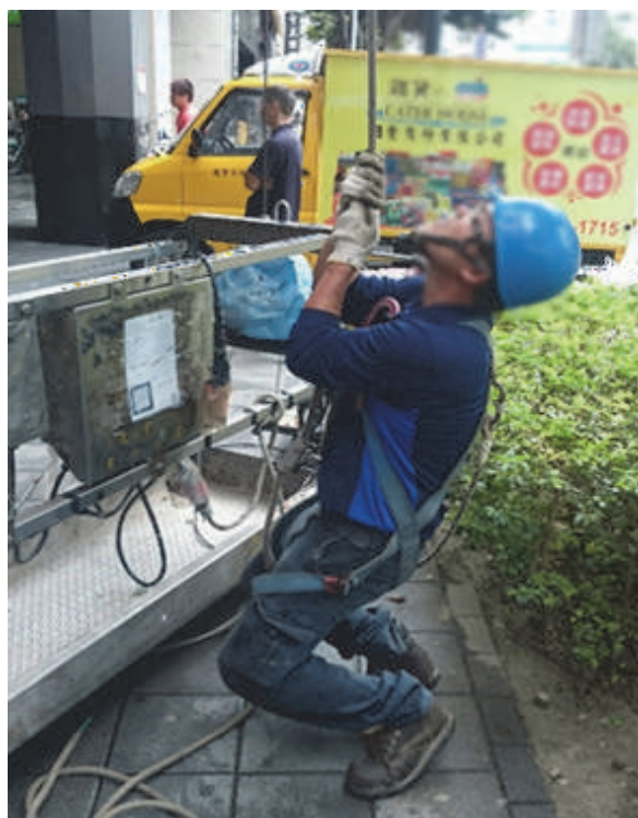
圖 4-67 救命用纖維索試拉測試
