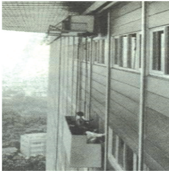
圖 1-5 單軌懸垂型吊籠(軌道式，工作台式)
