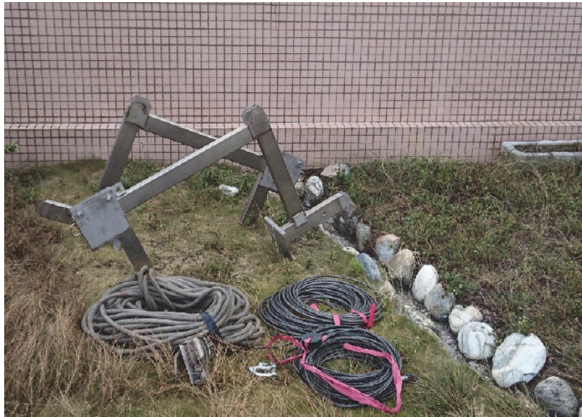
圖 4-28 F 型支架-屋頂安裝準備
