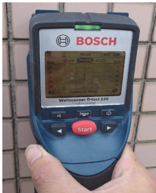
圖 4-27 金屬探測器檢測牆面中是否有鋼筋
