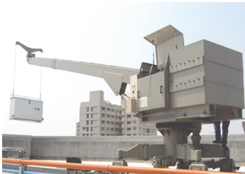
圖 1-3 吊臂俯仰型吊籠(軌道式，工作台式，本體旋轉，前端旋轉)
