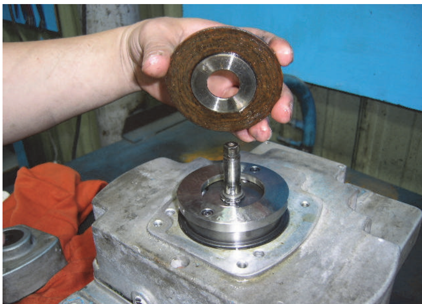
圖 4-11 可搬型吊籠自動控速裝置
