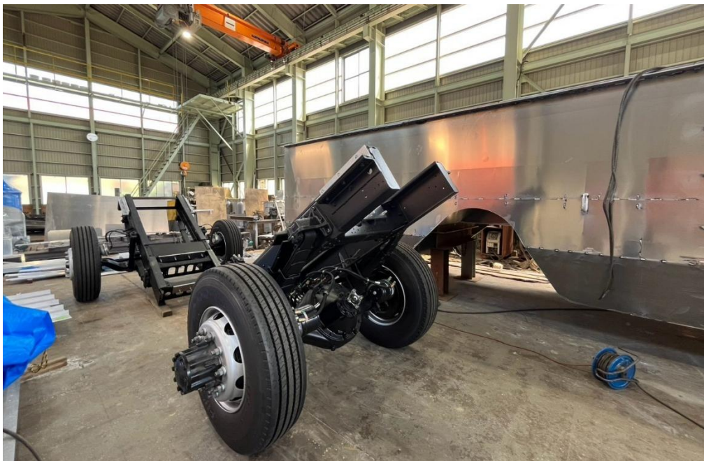
圖 22 本案水陸兩棲運具之底盤前後輪結構（圖片來源：本案拍攝）
