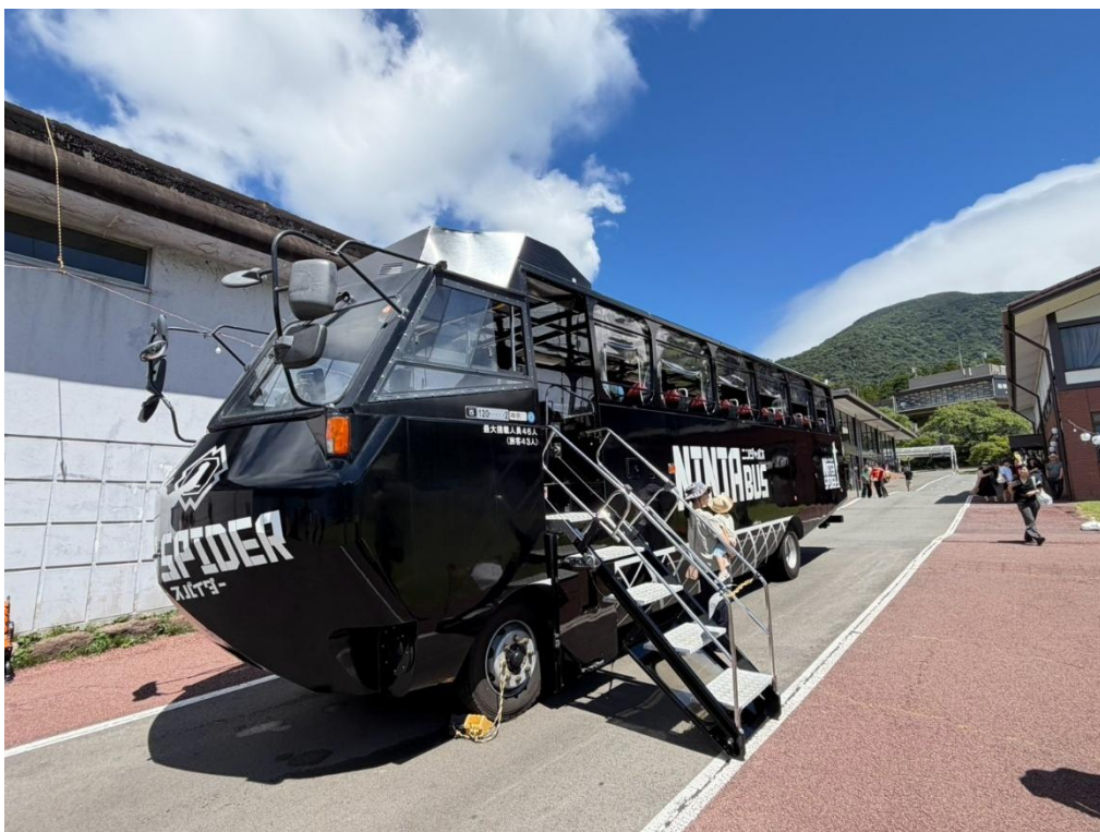
圖 37 現役 NINJA BUS 外觀，NINJA BUS 為日規運具採右駕版規格，乘客上下車的階梯位於運具左側。(圖片來源：本案拍攝)
