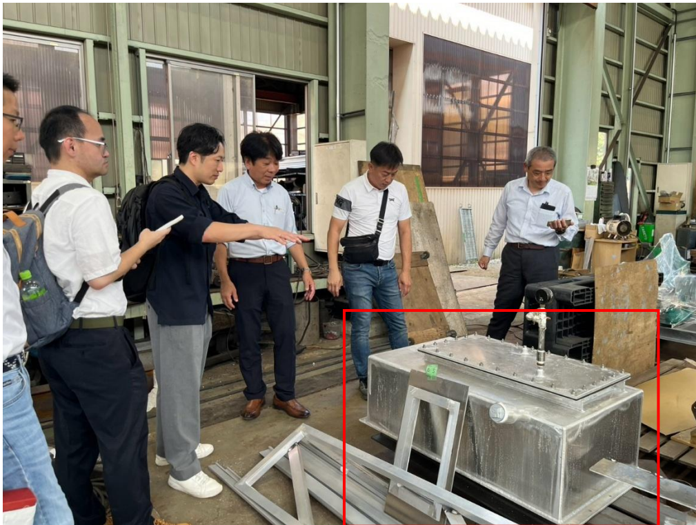
圖 25 本案運具配置 200 公升油箱（紅框處），依日方估算，滿載時陸上續航里程約 800 公里；因水域航行阻力較大，水域續航里程約為陸上之一半。 （圖片來源：本案拍攝）
