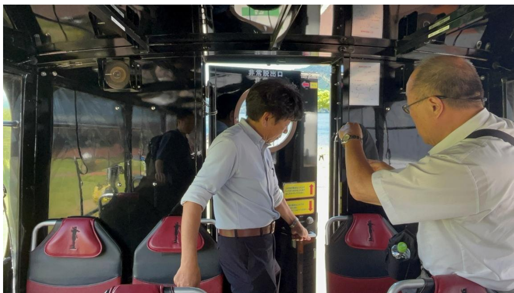
圖 49 日本製造商代表示範運具後方安全逃生門之開啟方式；逃生門開啟後，系統將發出警報聲，提醒船長注意。（圖片來源：本案拍攝）
