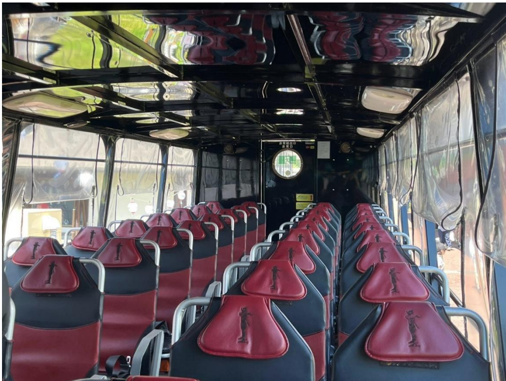
圖 40 NINJA BUS 內部座椅配置，窗戶無裝設玻璃，以透明捲簾提供基本防護（圖片來源：本案拍攝）
