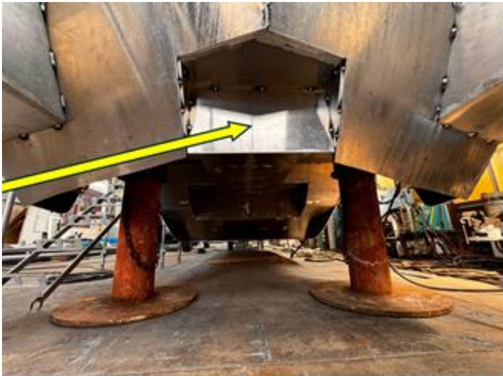
圖 6 水陸兩棲運具打造現況－3，船艙結構（水密隔艙壁）（圖片來源：本案拍攝）
