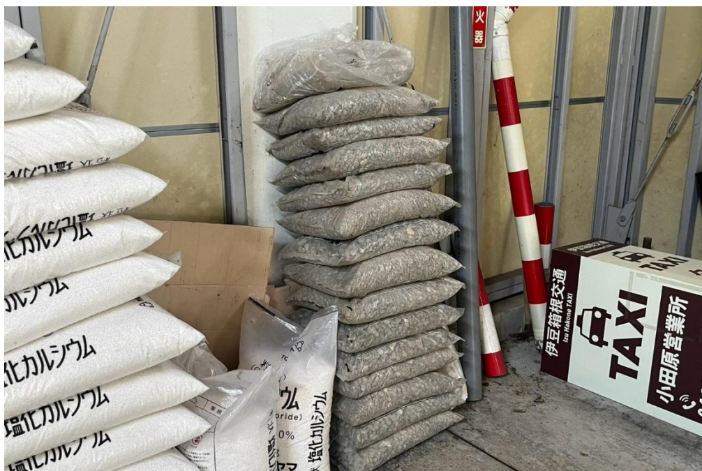
圖 64 車庫內備有沙袋，作為車輛驗車時之配重使用。驗車時須依成人體重約 60 公斤之 1.5 倍估算，配置約 90 公斤之配重。(圖片來源：本案拍攝)
