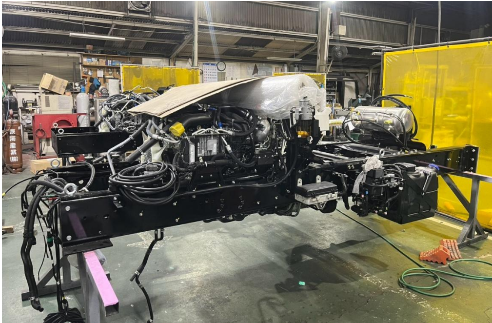
圖 17 位於湘南的辦公工廠，本府訂製水陸兩棲運具的兩座 ISUZU 左駕版底盤（圖片來源：本案拍攝）
