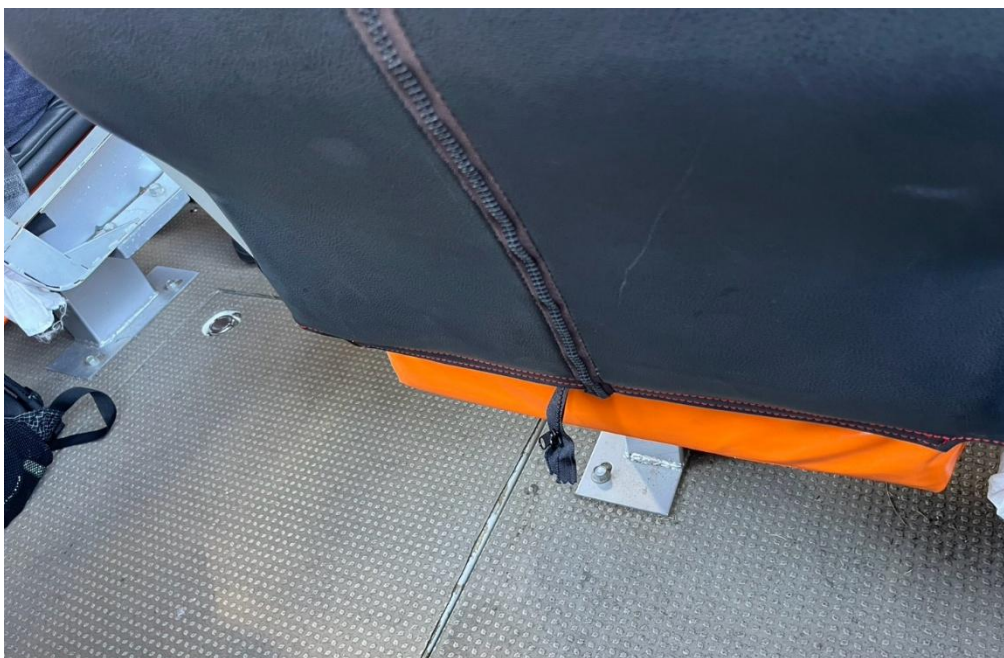
圖 42 緊急救生浮板均配置在座椅下方（圖片來源：本案拍攝）
