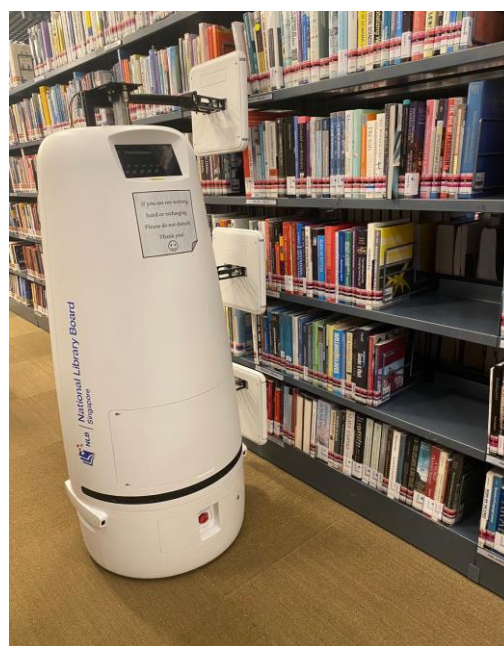
圖 34 掃描機器人正在掃描書架上圖書 圖 35 掃描機器人掃描確認圖書位置
