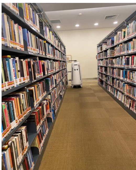
圖 34 掃描機器人正在掃描書架上圖書 圖 35 掃描機器人掃描確認圖書位置
