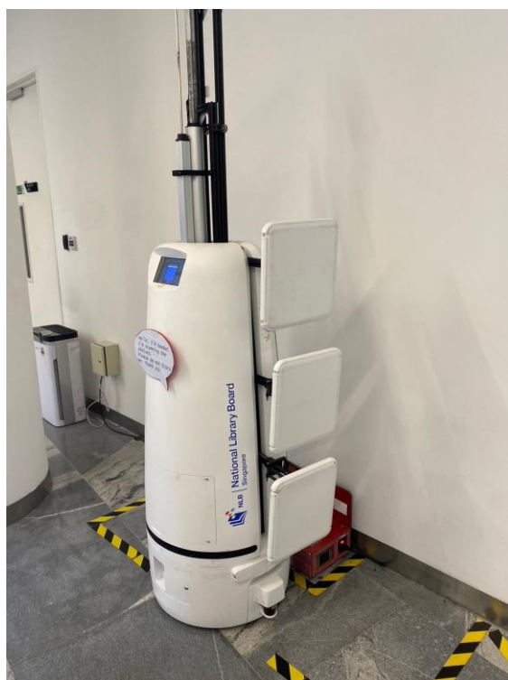
圖 4 掃描機器人可掃描、定位、優化調整圖書擺放位置
