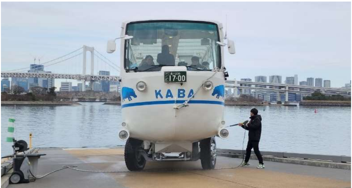
圖 100 自動清洗不足的地方，仍需以人力加強清洗，如後照鏡、前玻璃及接縫處
