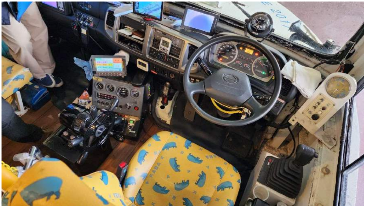
圖 102 KABA 水路兩用運具，具有雙駕駛系統，兼具公車及客船的機能，亦需有雙駕駛才能上路。
