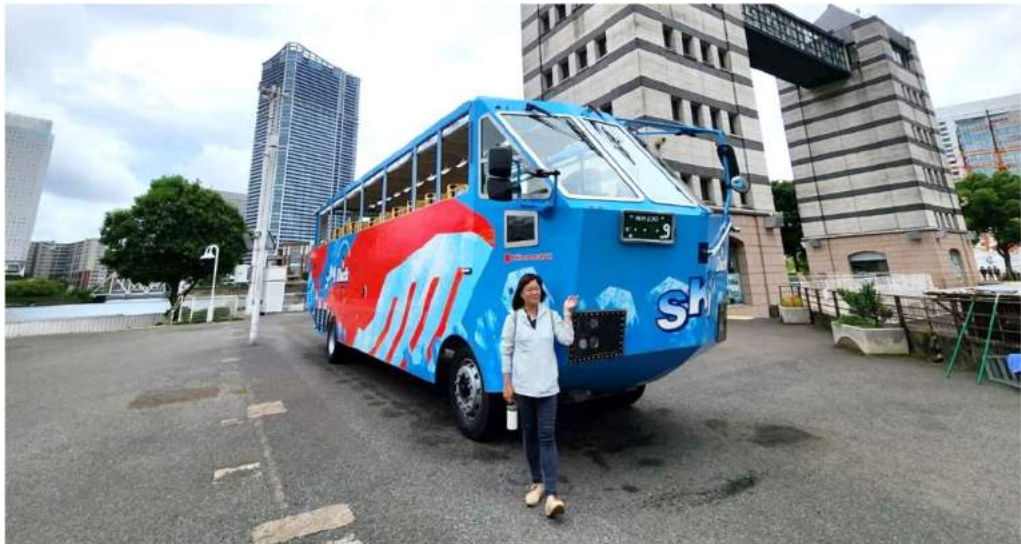
圖 62 橫濱市 SKYDUCK 車體外觀，本款是由美國軍規水陸兩用系統改造
