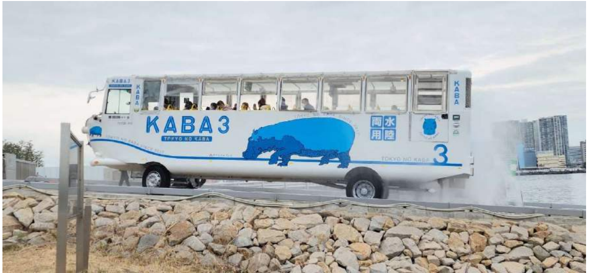
圖 96 為了防止海侵蝕，KABA 上岸後車體都必須進行水柱清洗
