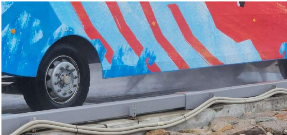
圖 97 為了防止海侵蝕，SKY DUCK 上岸後車體都必須進行水柱清洗，此為車底水柱
