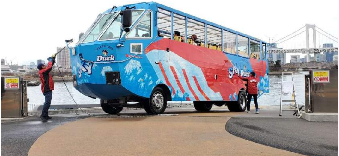
圖 99 自動清洗不足的地方，仍需以人力加強清洗，如後照鏡、前玻璃及接縫處
