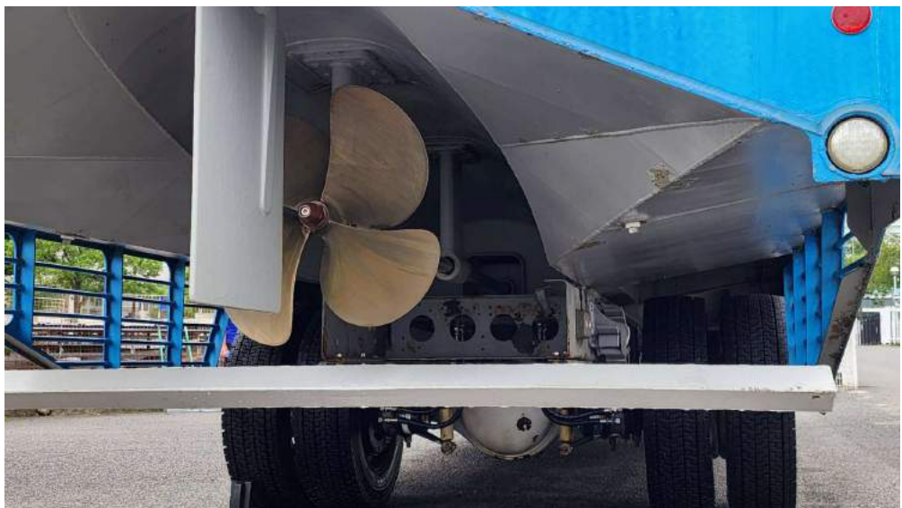
圖 63 SKYDUCK 水路兩用運具，具有兩套引擎，船用螺旋槳及公車引擎。
