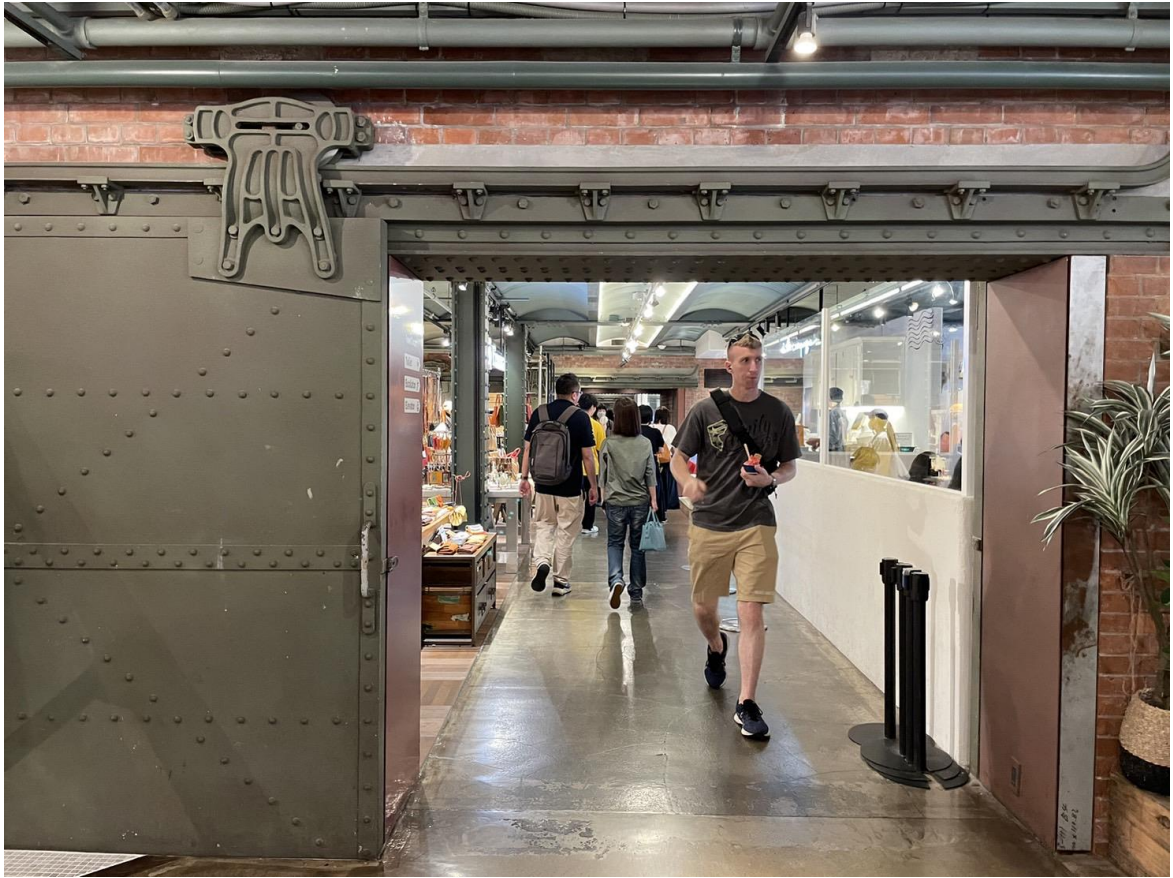
圖 14 紅磚倉庫內防火門和掛門保留舊倉庫設計，原設計是若倉庫不幸有火災發生時，可將防火門關閉以防止火勢蔓延
