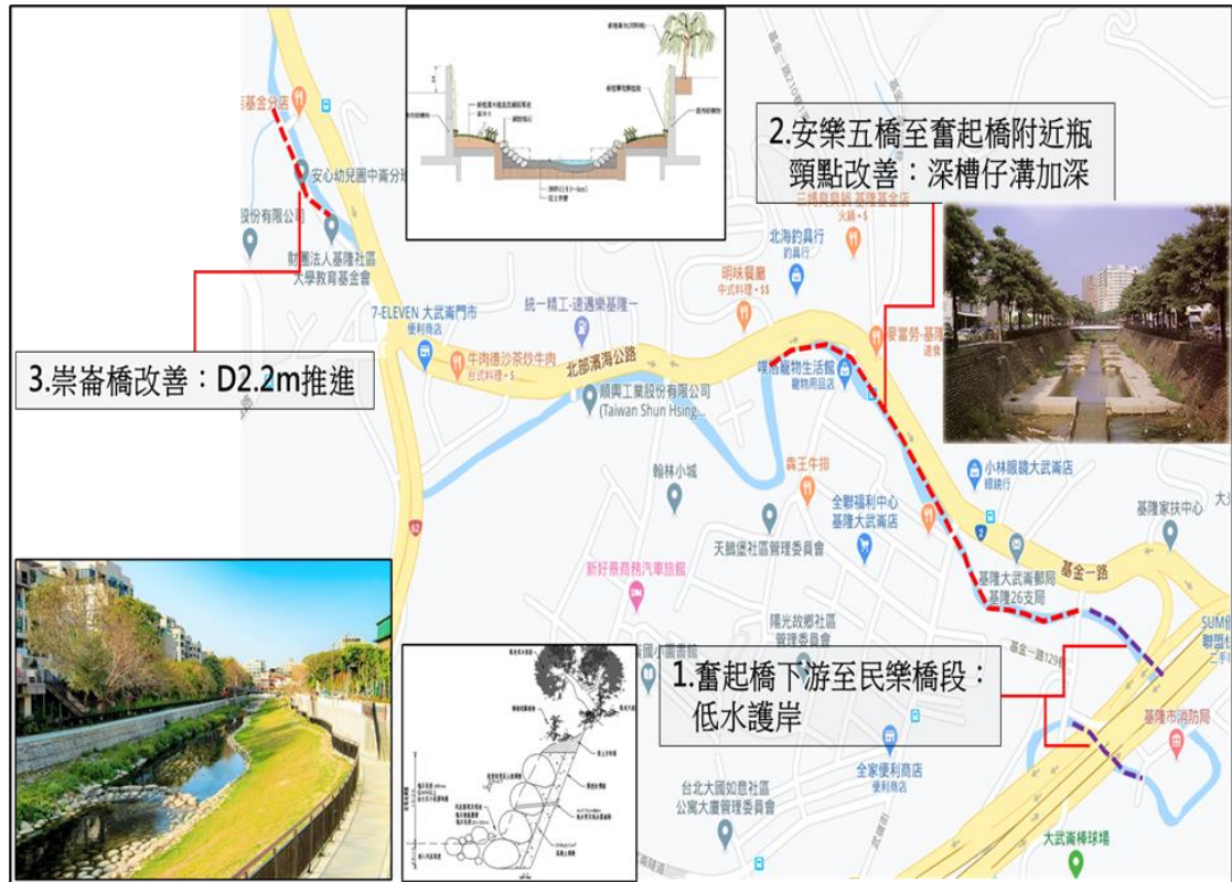
圖 56：大武崙溪順興橋至民樂橋段改善工程
