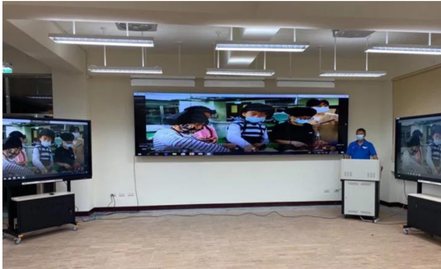
圖 9：明德國中 8 台工業級窄邊液晶螢幕拼接成大型「電視牆」
