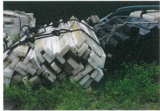
HDPE 固定板及防舷材堆置陸地
