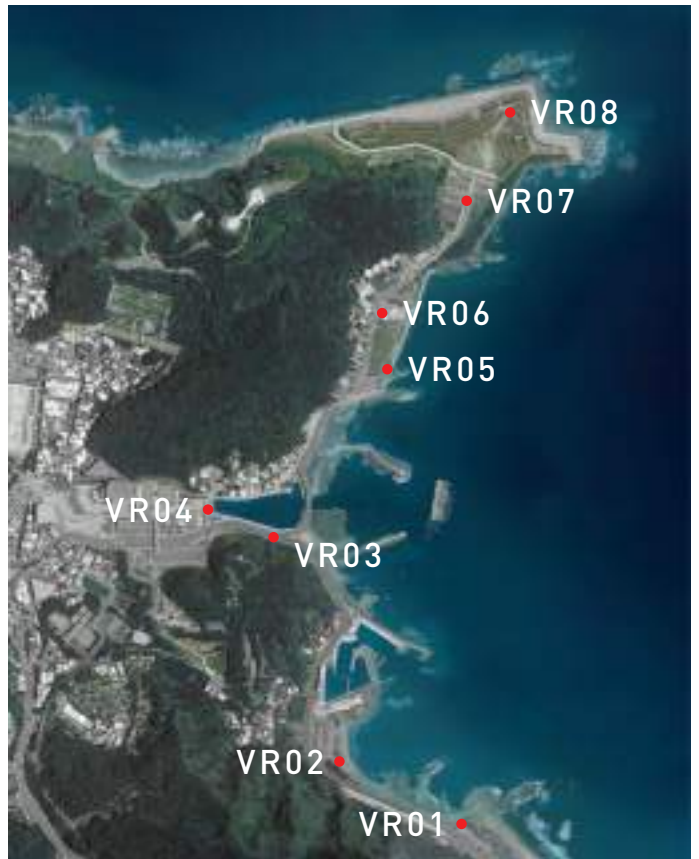
本案測量設定GPS衛星定位引測基準點
